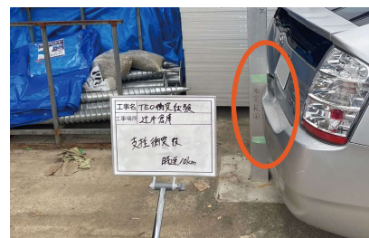
▲ 支柱衝突試験 (10km/h)
