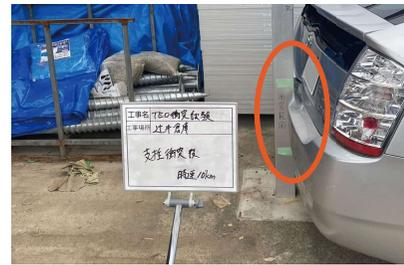
▲ 支柱衝突試験 (10km/h)
