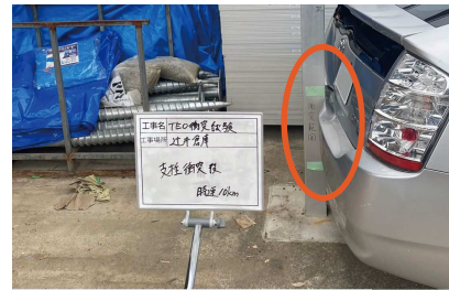
▲ 支柱衝突試験 (10km/h)
