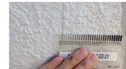
★ひび割れの確認の様子(ひび割れの幅：0.1mm) 0.3mm未満のひび割れは「軽微」と判断できます★
