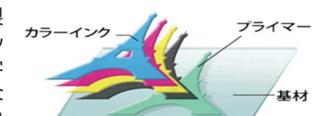
★UVプリントの仕組み★
