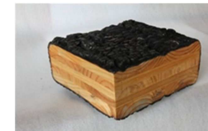
★断面を大きくして燃え残りを確保★
